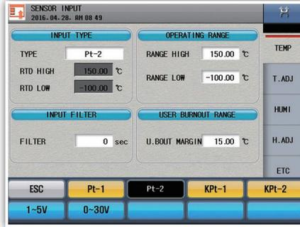
Fig. 61) Temperature sensor change
