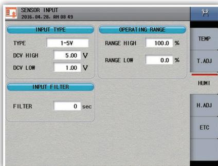
Fig. 62) Humidity sensor setting
