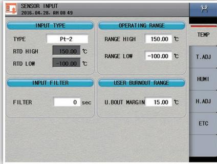
Fig. 60) Temperature sensor change
