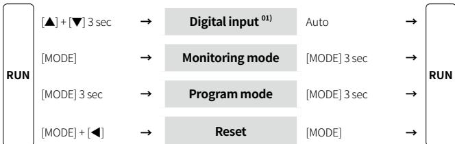
01) P1-34, P2-30 Digital input key (HOLD: hold display value or ZERO: remote zero)
